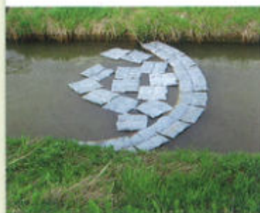
▲オイルワイバーは川や海などに流出した油の上に置くだけで、短時間のうちに油を吸着する
